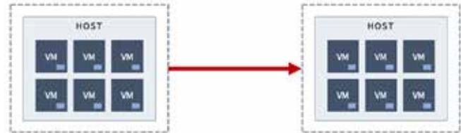
Abbildung 6. Host-basierte Replikation erfordert einen Agenten auf jeder VM, was die Komplexität erheblich erhöht.
